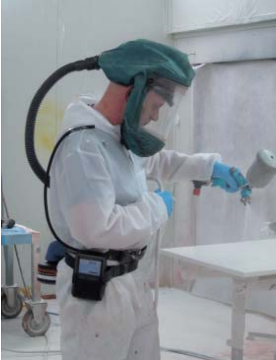
FIGUR 1. Eksempel på god praksis for en arbejdstager, der sprøjtemaler med lak indeholdende fremstillede nano-materialer. Vakuumentilations-væg, Tyvek-dragt, nitril-handsker, luftstrøms-hjelm med FFP3-filterenheder beskytter effektivt mod flygtige organiske forbindelser og samtidig mod luftbårne fremstillede nano-materialer.
